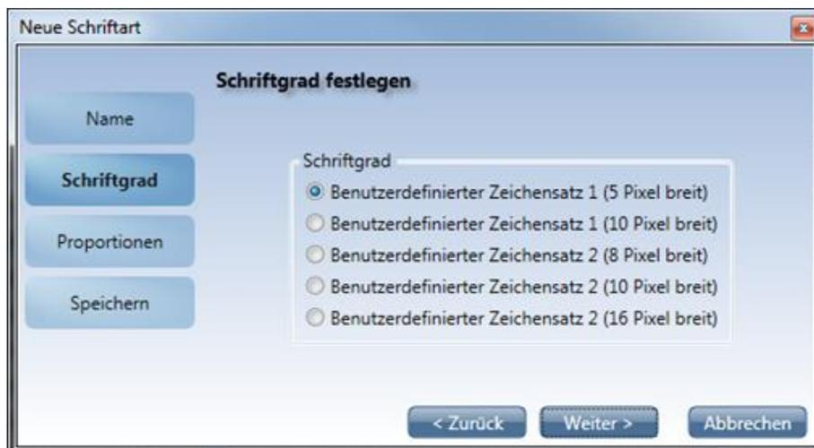
Legen Sie über den **Schriftgrad** die Abmessungen der Zeichen fest. Der Schriftgrad legt die Breite und die Höhe der Zeichen in Pixel fest. Der Benutzerdefinierte Zeichensatz 1 besitzt eine Höhe von 7 Pixeln. Der Benutzerdefinierte Zeichensatz 2 besitzt eine Höhe von 16 Pixeln. Die Benutzerdefinierten Zeichensätze stehen jeweils in unterschiedlichen Breiten zur Verfügung. Klicken Sie auf die Schaltfläche **Weiter**.
