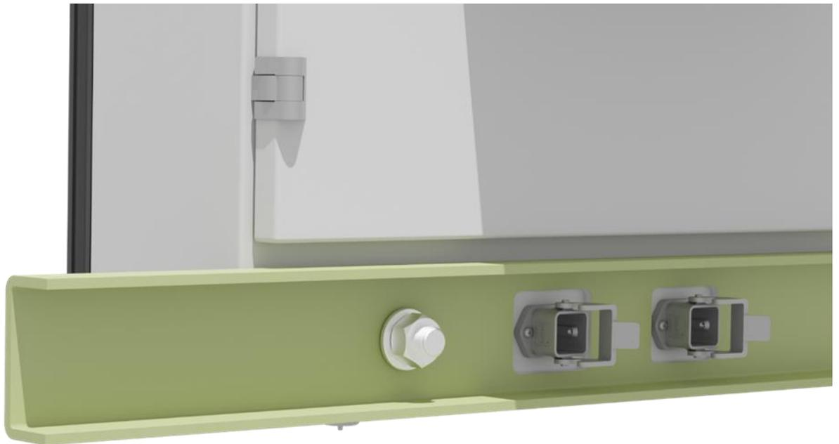
La fixation de chaque module sur les rails porteurs s'effectue à l'aide de 6 écrous et rondelles M16 (inclus dans la livraison).
