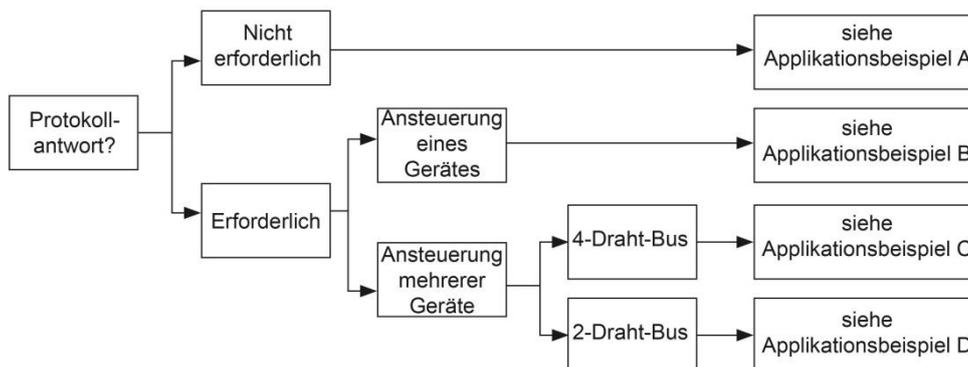
Se il dispositivo non deve mandare una risposta protocollo (normalmente) vale l'esempio di applicazione A per il pilotaggio di uno o più dispositivi.
