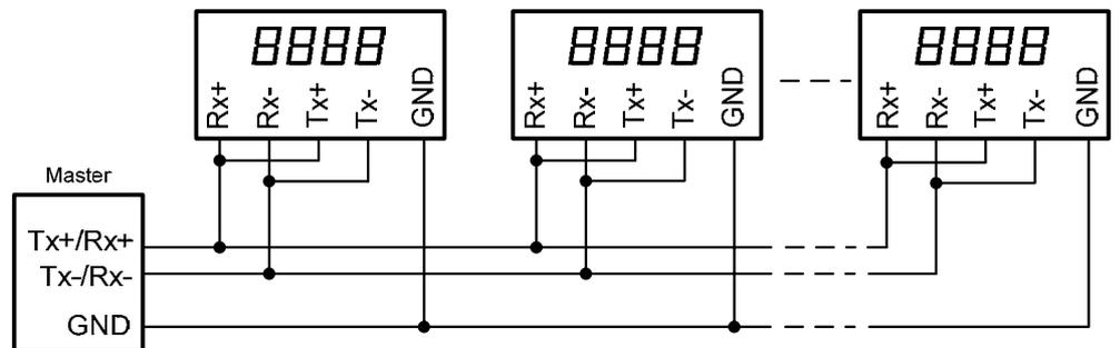
Il est également possible de réaliser le câblage de raccordement d'un bus RS485 4 fils (Optional Four-Wire Modbus Definition) comme représenté sur le schéma ci-dessous.
