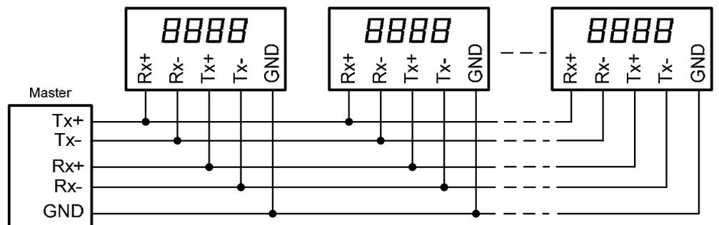
Lorsque la liaison Modbus n'est constituée que d'un afficheur et d'un organe de commande comme représenté sur le schéma ci-dessous (point à point), l'option RS485 peut être également sélectionnée à la phase 1 du menu.
