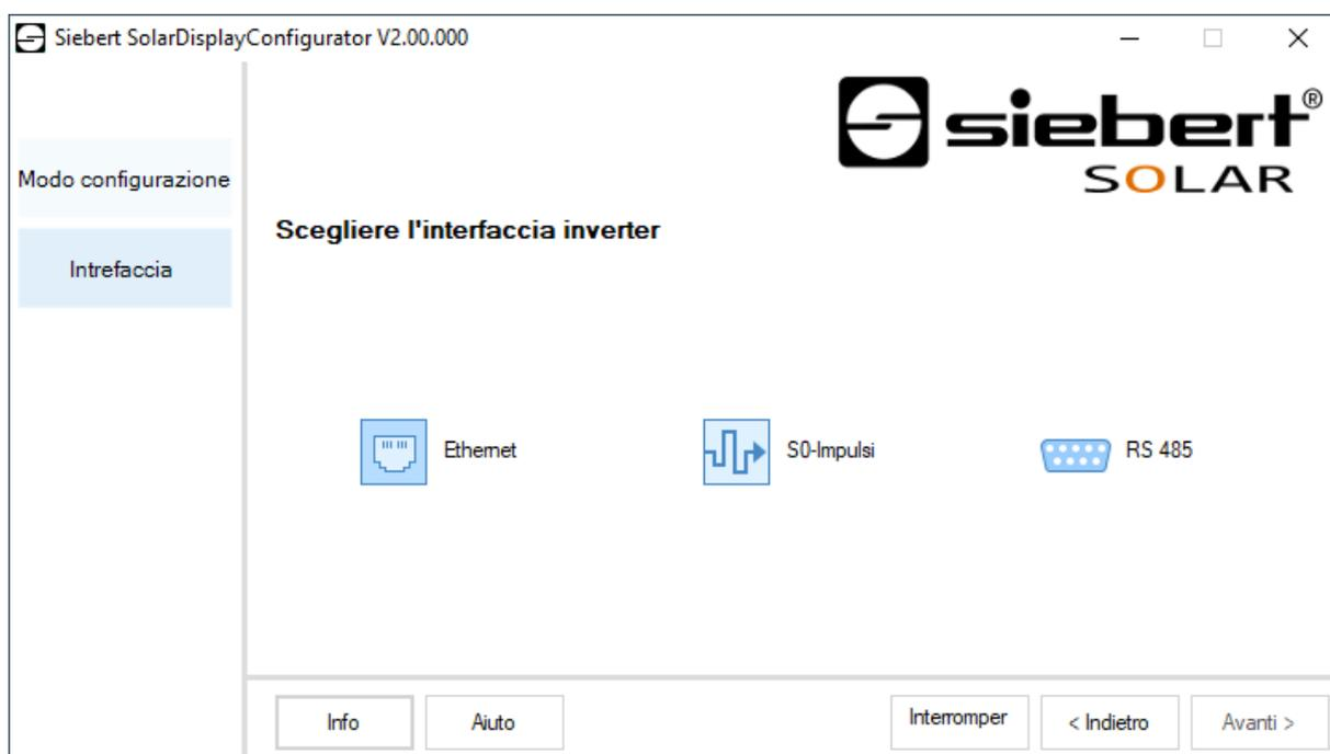
Se l'inverter e/o il registratore di dati viene collegato con il display tramite interfaccia S0 e/o un uscita impulsi, selezionare 'S0-Impulsi'.
