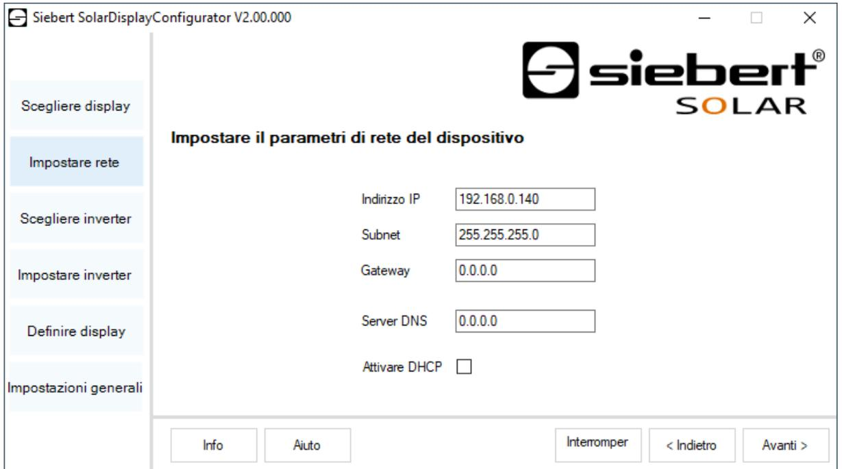
Se si seleziona l'opzione 'Attivare DHCP' (Dynamic Host Configuration Protocol), il display viene integrato automaticamente nella rete già esistente. Nella rete deve essere disponibile un server DHCP, che trasmette al display l'indirizzo IP, la maschera di sottorete e il gateway.
