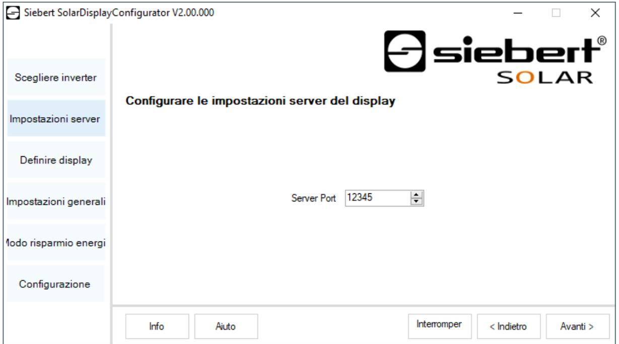
In alcuni registratori di dati Ethernet, il display deve fungere da server e il registratore di dati si connette come client al display. Sotto 'Server Port' viene indicata la porta di rete attraverso la quale il client si può connettere con il display. Affinché il registratore di dati possa stabilire la connessione con il display, l'indirizzo IP del display e il Server Port del display devono essere inseriti dal registratore di dati nella configurazione.
