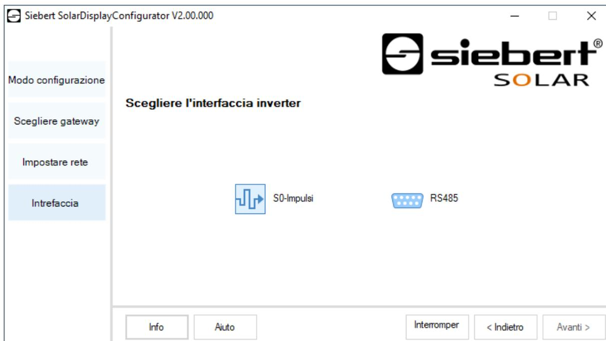
Nella modalità 'Gateway' bisogna scegliere l'interfaccia dell'inverter da collegare al Gateway Ethernet di Siebert. I dati dell'inverter possono quindi essere richiamati e presentati da un display per fotovoltaico di Siebert con interfaccia Ethernet del Gateway Ethernet di Siebert.
