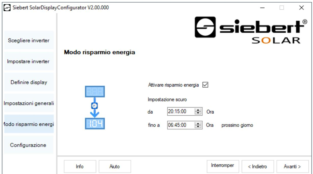
Con questo passaggio è possibile inserire e disinserire la modalità di risparmio energetico. Quando la modalità di risparmio energetico è attivata, il display viene spento per l'intervallo di tempo desiderato, ovvero il Display a LED del display viene spento e riacceso ad una determinata ora.
