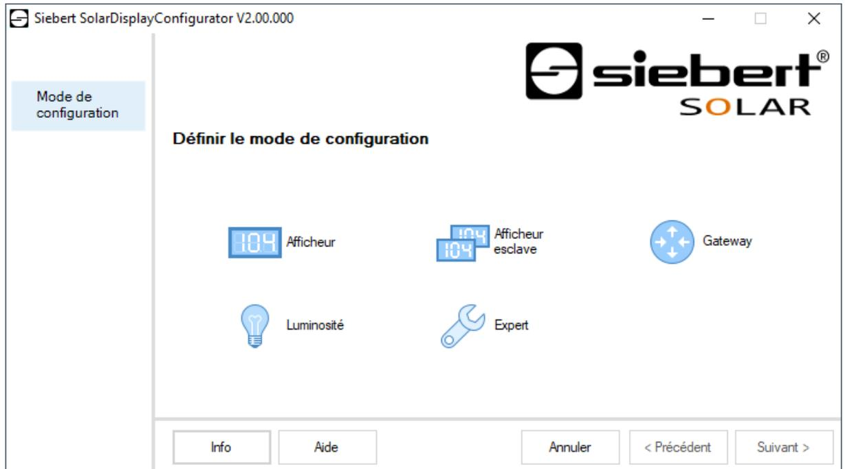
Le mode 'Afficheur' ou 'Gateway' entraîne la configuration complète de l'afficheur ou du Gateway. Dans ce cas, tous les paramètres nécessaires sont réglés.
