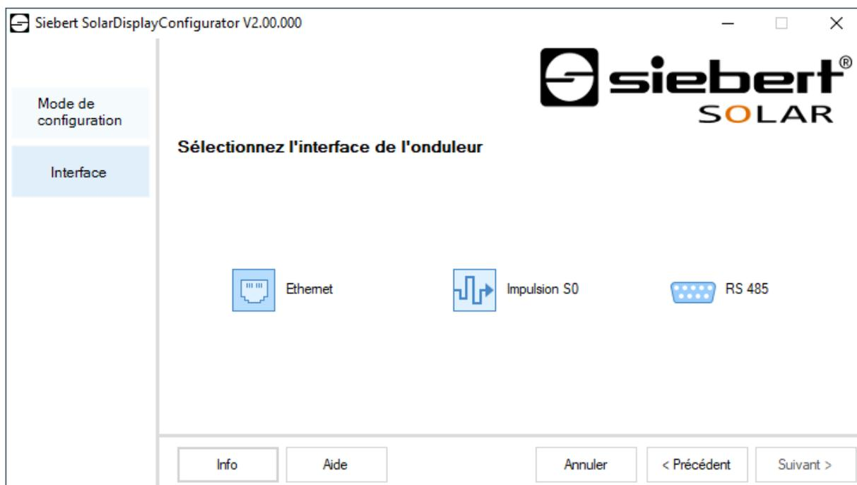
Si l'onduleur ou l'enregistreur de données est relié à l'afficheur par une interface S0 ou une sortie de comptage à impulsions, veuillez sélectionner 'Impulsion S0'.
