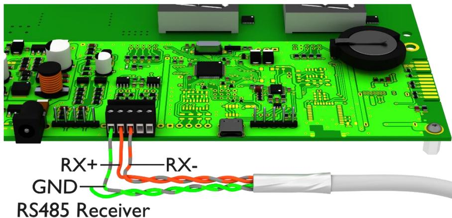
Le répéteur envoie également les données affichées par l'interface RS485, de telle manière qu'il est possible de monter plusieurs répéteurs en cascade.
